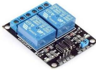
Gambar 7. Module Relay
