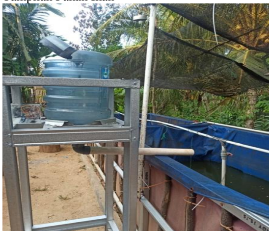
Gambar 16. Tampilan Alat Pakan Ikan Otomatis.
