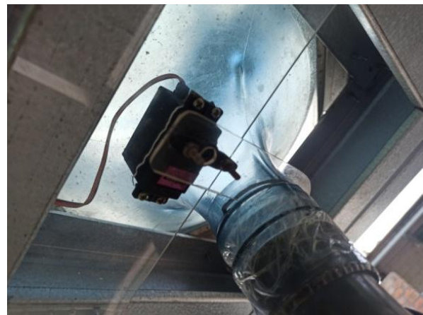
Gambar 14. Tampilan Rangkaian Servo MG996R.
