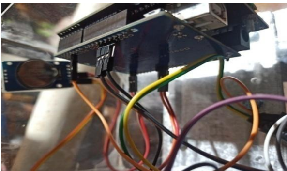
Gambar 12. Tampilan Rangkaian RTC DS3231.
