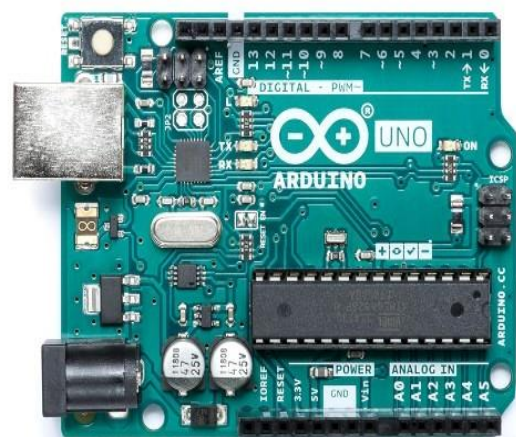
Gambar 1. Board Arduino Uno Bagian-bagian Microcontroller Aduino Uno adalah sebagai berikut:
