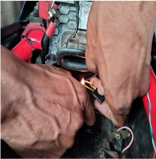
Gambar 20. Tampilan Pemasangan Kabel Kontak Pada Relay 2 channel
