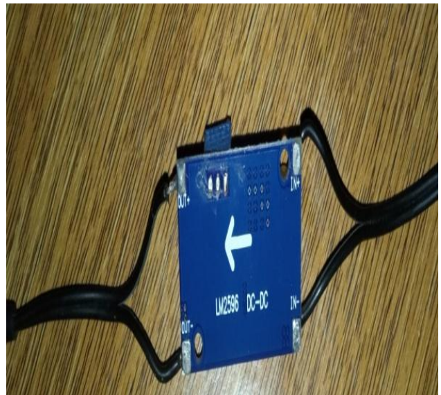
Gambar 11. Tampilan Stepdown terhubung ke Modul arduino uno
