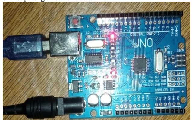
Gambar 12. Tampil kabel adaptor ke arduino
